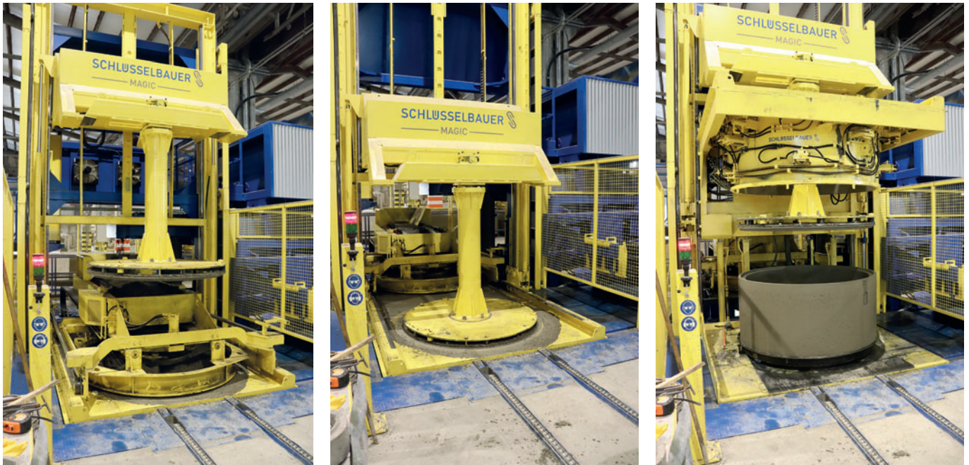
Заполнение системы Magic бетоном. Процессы виброуплотнения и выгрузки готового продукта полностью автоматизированы
