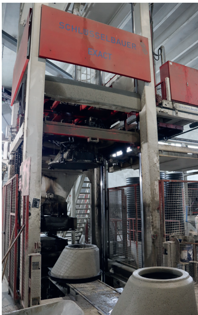
Модульная, полностью автоматизированная система Exact для производства труб и элементов бетонных колец с днищем успешно используется на заводе в Золленау с 1998 года
